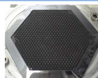
図11 開発中220GHz 750素子MKIDS用のレンズアレイ
