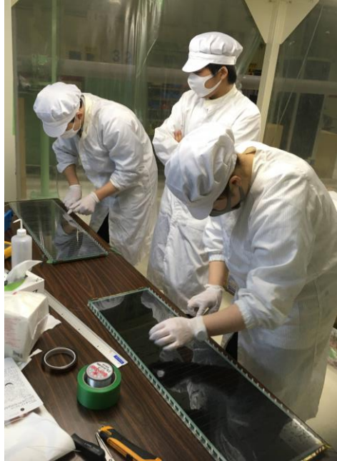
Spring-8でのMRPC試験機製作(2020年)
