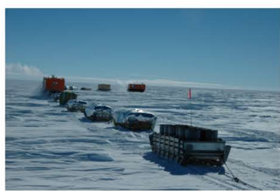
(b) 雪上車+そり 沿岸からドームCへの輸送の基本（片道12日間）。
