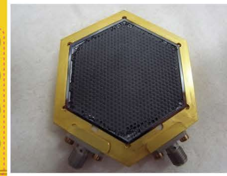
図12 プロトタイプ220-GHz帯600素子カメラ。
