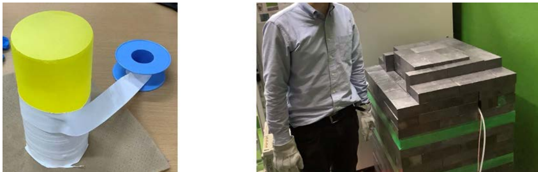
図 38 (左) 金研で作製した大型 GFAG 結晶に反射材のテフロンテープを巻いているところ。(右) 神岡地下実験室の鉛シールドで 7 月に行った実験の様子。
