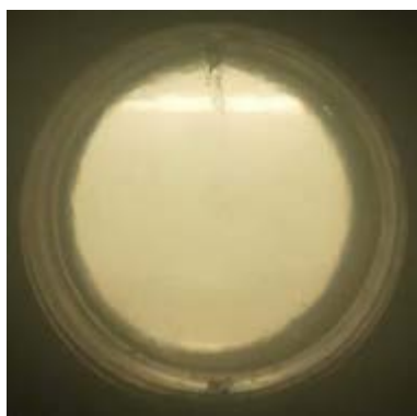
図 74 固化した重水素の様子。
