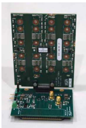
図 58 ELPH 実験で用いた FoCal-E PAD モジュール
