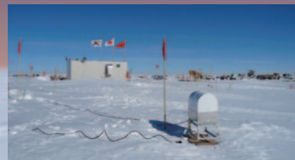
ドームふじで大気の光学的厚さを測定中のラジオメータ。
