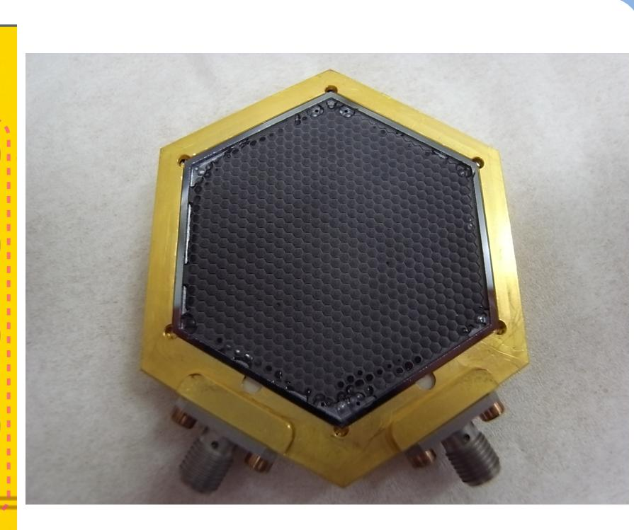
図12 プロトタイプの220-GHz帯600素子カメラ。
