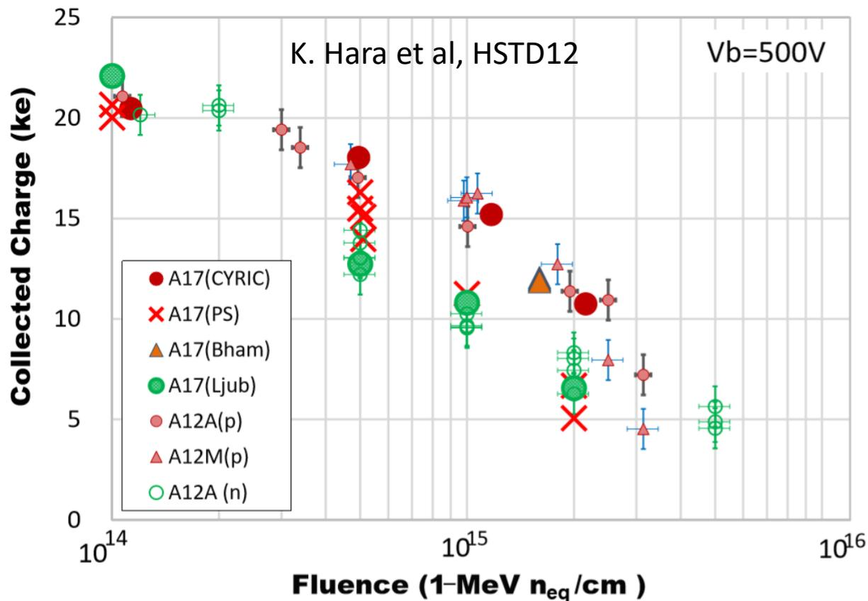
電荷収集量の低下: キャリアのトラップ
