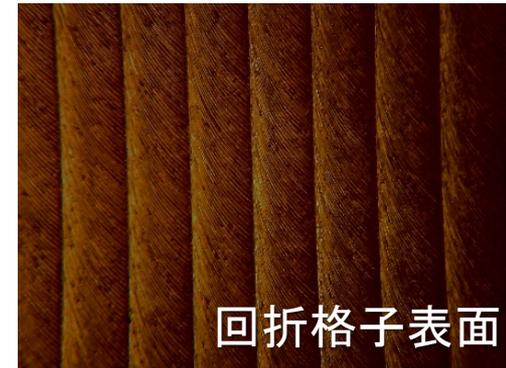
波長47.6 $\mu$ m, 回折格子:365 $\mu$ m\_Al蒸着
