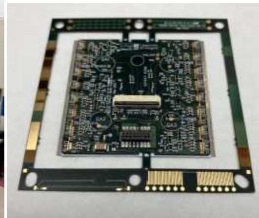
千葉県館山市のクリーンルームでの品質管理の様子と、試験量産されたピクセルモジュール
