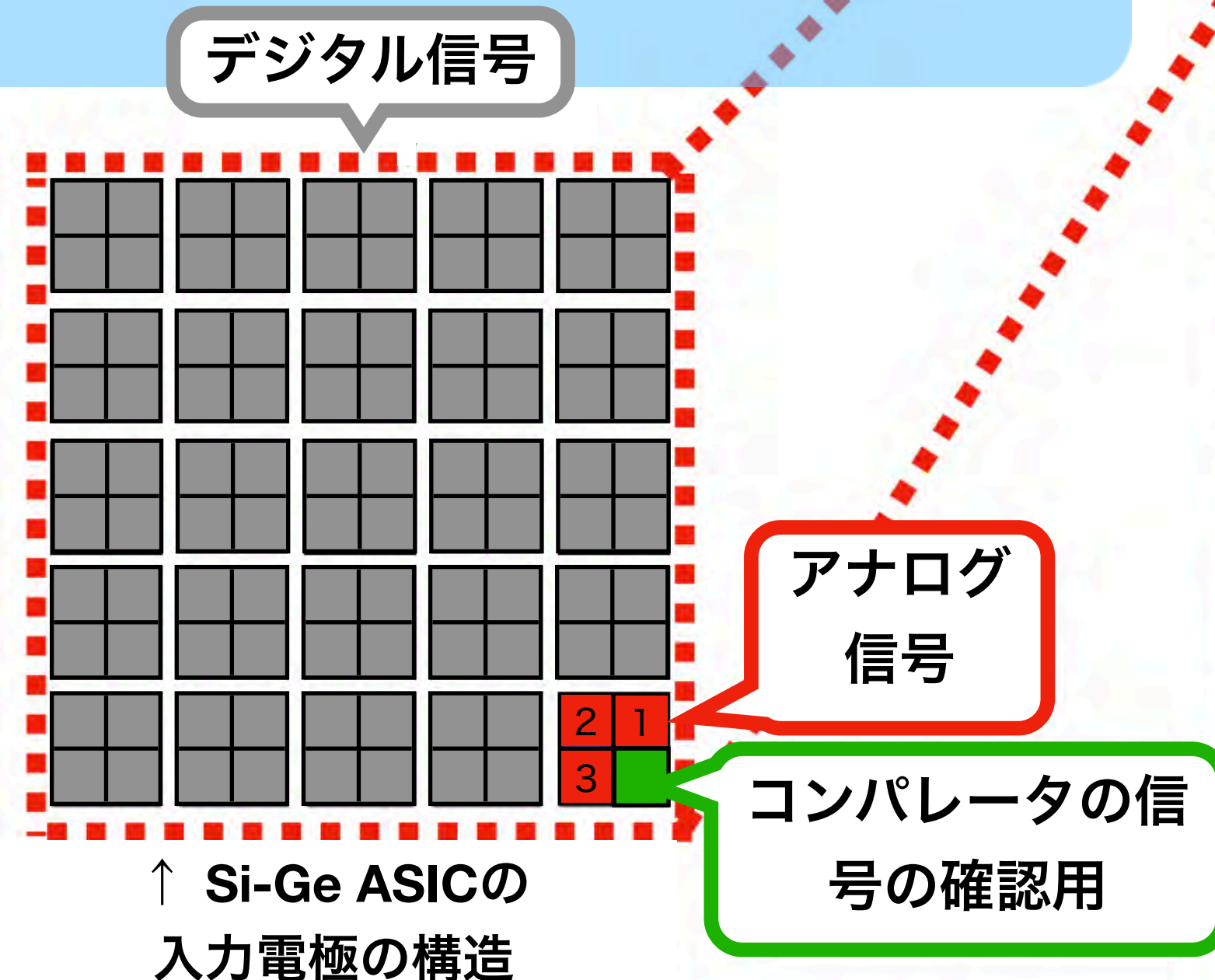
↑ Si-Ge ASICとAC-LGADpixの接続の様子
